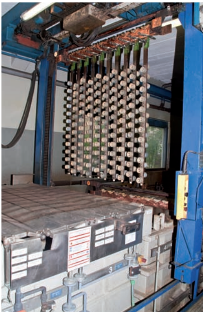
Das Bild zeigt das Hartverchromen von AGR-Ventil-Einsätzen. Dabei muss ein nur 6/10 mm breiter Steg gleichmäßig beschichtet werden
