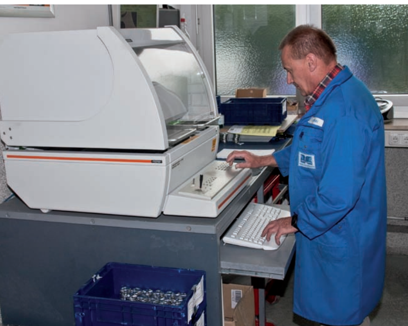
Da Ebenheit und Fehlerfreiheit der Beschichtung für die Funktion des Ventils entscheidend sind, erfolgt eine 100 Prozent Kontrolle.
