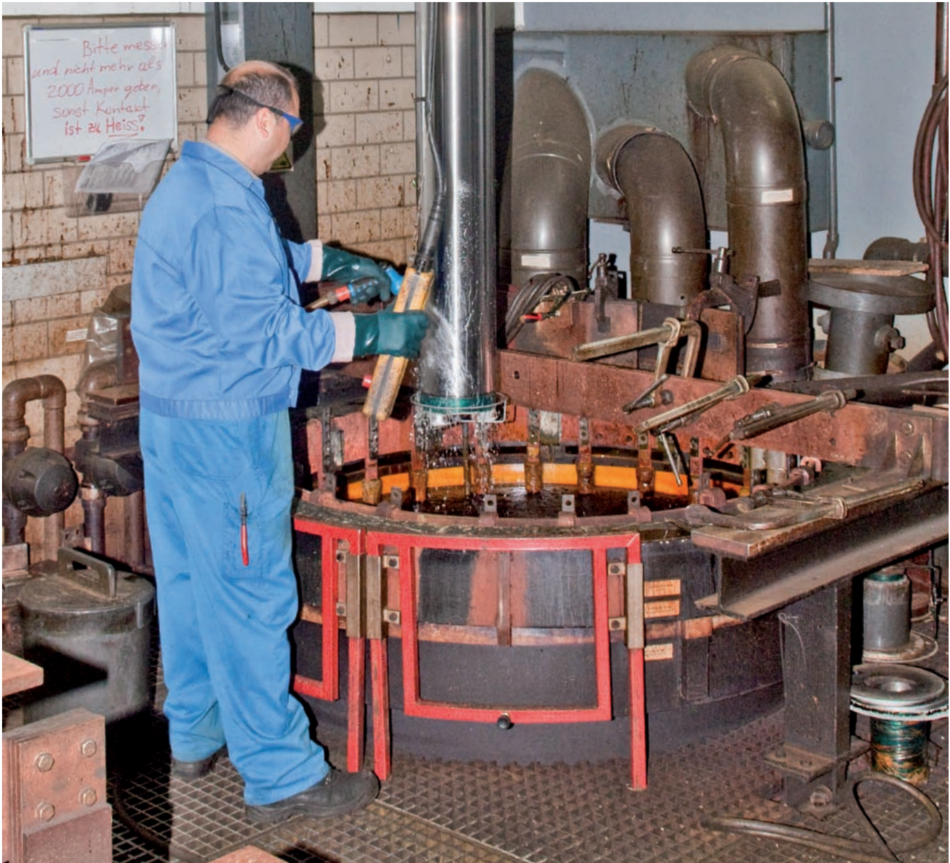
Das Beschichtungsspektrum bei Betz-Chrom umfasst überwiegend kleinere und mittlere Serien bis hin zu Einzelteilen wie dieser Kolbenstange.
